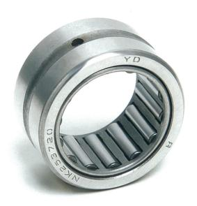
YFB一实体套圈滚针轴承是一种断面高度小承载能力高的轴承。由于外圈硬度高,即使是轻合金轴承座,也可以应用自如。这种轴承可提供公制及英制二个系列的产品,稳中有降系列都有带保持架、满针型及密封型三种结构。此外,实体套圈滚针轴承可分带内圈或不带内圈二种,不带内圈者以心轴作为滚道面,使体积变得更小。
